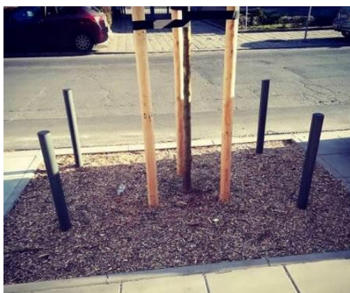
Ryc. 34. Zabezpieczenie powierzchni biologicznie czynnej za pomocą ograniczników wjazdu. Fot.. Piotr Drozda.
